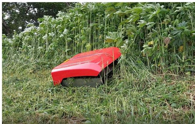
従来の草刈りは、肩掛け式のエンジン草刈り機が多く、作業しにくい傾斜地での安全性、作業効率が課題となっていました。本商品は、ラジコンによる簡単な操作で、100mの遠隔操作が可能な草刈り機です。全電動のため騒音も小さく、草丈1m以上の草刈が可能で、独自のクローラーベルトにより安定性が高く、45度の傾斜地でも使用可能としたもので、新規性と技術が認められたものです。
